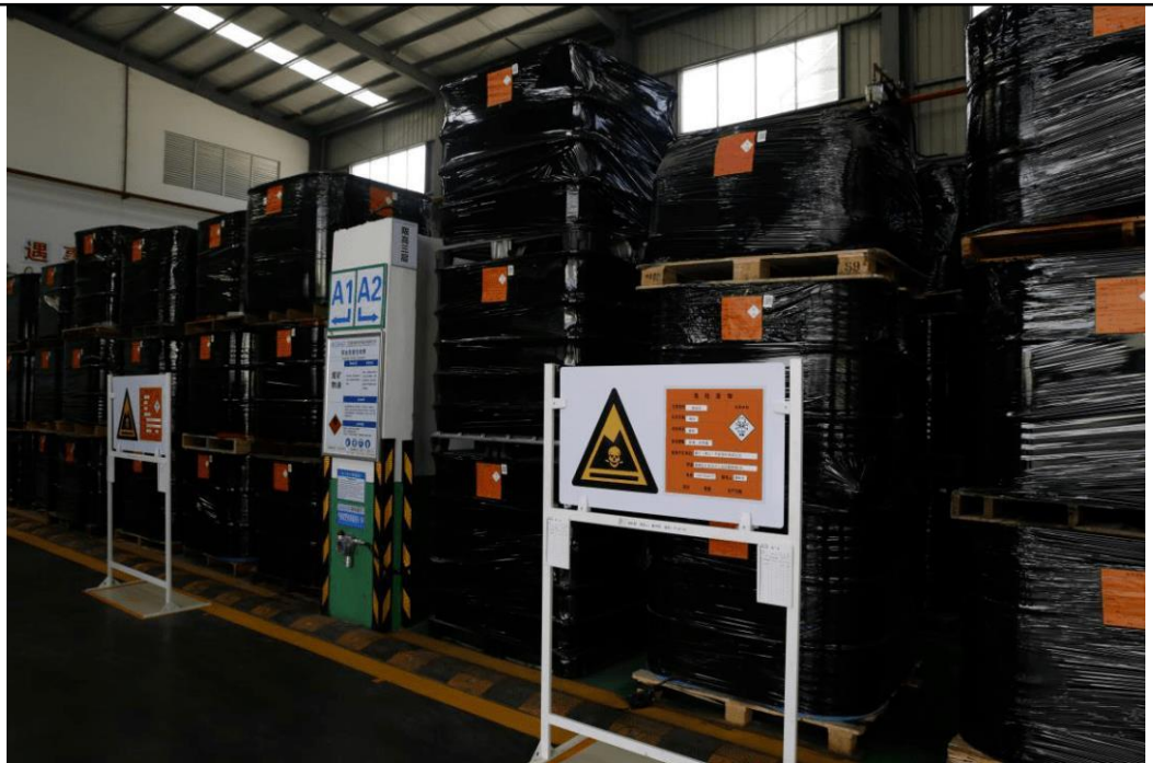
图 2-1 典型工业废渣危险废物地面三层堆叠形式
